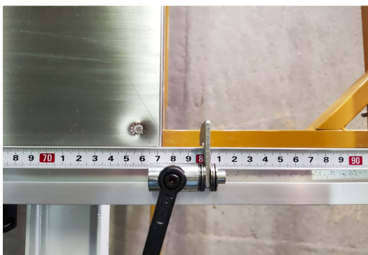
Линейка перпендикулярного упора с флажками для выставления точного размера реза детали.
