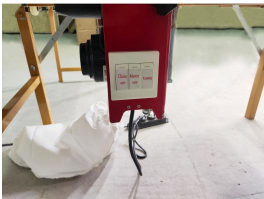
Панель управления для раздельного включения основной, подрезной пил и аспирации
