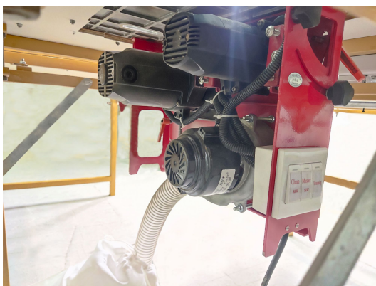
Пильный блок с раздельными моторами на основную и подрезную пилу и двигателем аспирационной установки
